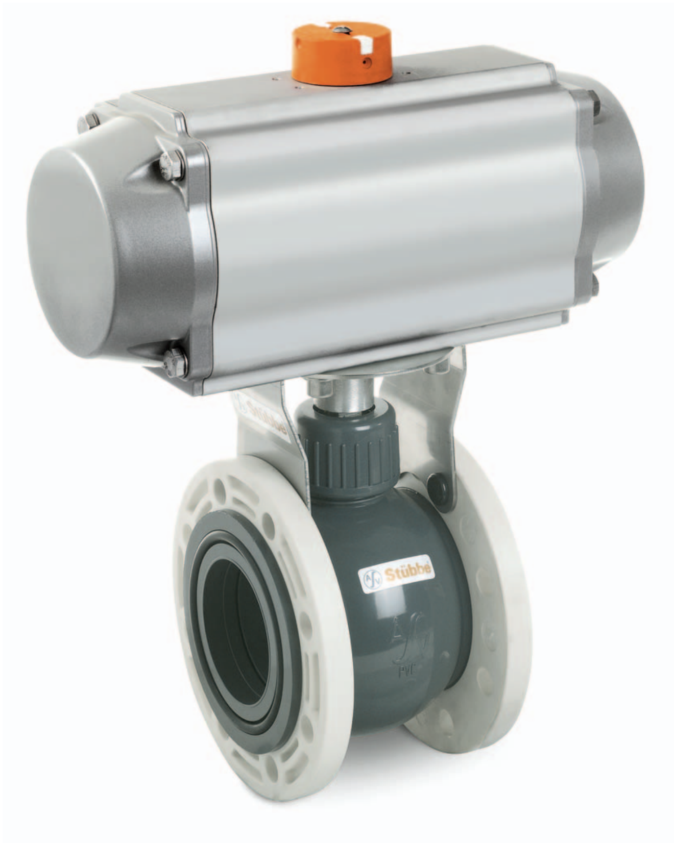
Zawór kulowy Compact 16, PVC-U, Kołnierz z GFK, z napędem pneumatycznym tłokowym, DN 65 - DN 150 ball valve Compact 16, PVC-U, GFR flanges, with pneumatic actuator, DN 65 - DN 150
